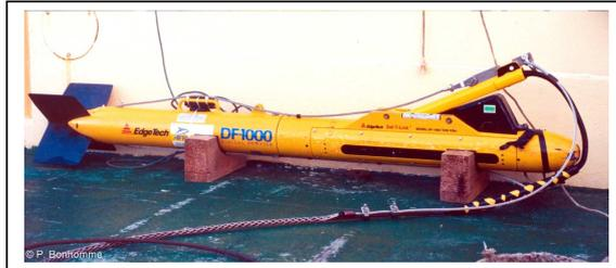
Il fonctionne selon deux fréquences 105 kHz et 390 kHz.
