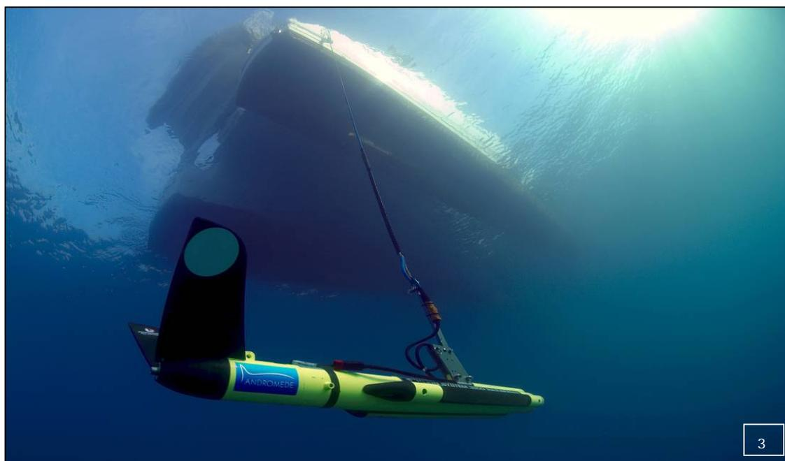
Levé sonar latéral Klein 3900 (1 : DGPS, micro-ordinateur avec logiciel SonarPro et enregistreur numérique ; 2 : retour contrôle pour pilote ; 3 poisson relié au bateau par le câble électroporteur
